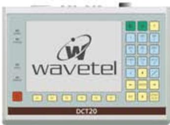
L'analyseur numérique DCT20 est un instrument de mesure portatif dédié à la mise en service et à la maintenance des liens 2 Mbits/s. Le DCT20 peut fonctionner en mode tramé ou non tramé et effectuer des mesures de bout en bout ou face à une boucle. Avec l'option data le DCT20 vérifie les interfaces V24, V35 et V11 en mode synchrone ou asynchrone.
