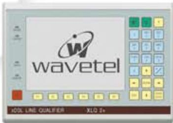
Les équipements XLQ2+/XLQ30 permettent de qualifier, surveiller et maintenir les paires de cuivre (technologie RNIS et XDSL). Les tests automatiques intégrés fournissent un diagnostic immédiat et précis de l'état de la ligne. Ces préqualificateurs intègrent des fonctions avancées de localisation de défauts (échomètre, multimètre ou pont de mesure).
