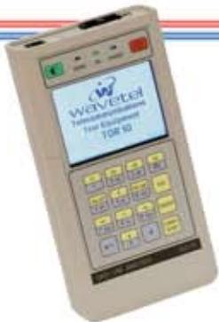
ELA-10 est un équipement de test portable dédié à la validation des liaisons spécialisées analogiques et RTC dans une gamme de fréquence 20 Hz to 20 (85) kHz.
