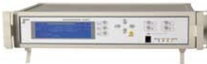
SIMDESC est une gamme complète de simulateurs de réseau téléphonique RTC et de compléments de services sur lignes RTC implémentés sur les terminaux analogiques (Téléphones, DECT, FAX, Modems...)
