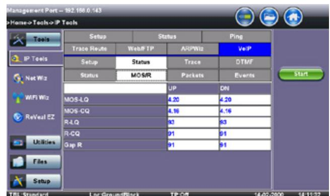
**VoIP Call Expert** – Emule un téléphone IP et peut passer et recevoir des appels utilisant les protocoles SIP ou H.323. Les solutions de support de Codec complet et de destination d'appels vérifient l'encodage de voix et le provisionnement de transposition. L'évaluation en temps réel de la qualité de voix subjective est possible grâce à l'utilisation de la méthode de test Telchemy.
