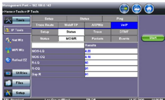
industrielles pour les valeurs MOS et R-Factor des chemins montants et descendants et inclut des mesures de QoS tels que la gigue et la perte de paquets et le Round Trip Delay. Compatible avec tous les testeurs VeEX incluant le logiciel serveur VX1000 VoIP.
