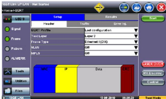
Un flux de trafic est transmis à travers le réseau en test et la vérification d'erreurs bit-par-bit est ensuite exécutée sur le trafic reçu. Les mesures d'interruption de service tout comme la vérification d'erreur CRC sont accomplies. Le test BER peut être exécuté avec une boucle physique (ou connecteur) à l'extrémité (pour une connexion couche 1) ou avec un second groupe de test ou avec un appareil intelligent de boucle retour en mode Smart Loop ou en mode Peer-to-Peer.
